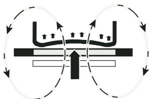
Falsch: der Geschirrboden ist gewölbt. Die Temperatur kann von der Elektronik nicht korrekt ermittelt werden.
